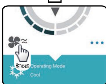
Като избирате всяка позиция така, както са показани на екрана, можете да настроите скоростта на вентилатора и посоката на въздушния поток. За подробна информация по всяка настройка, вижте в ръководството за експлоатация на климатика.
